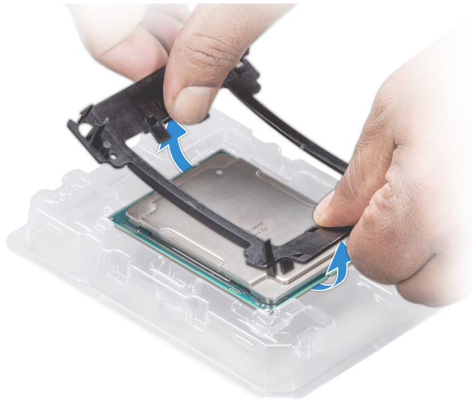
Figura 30. Extracción del soporte del procesador
