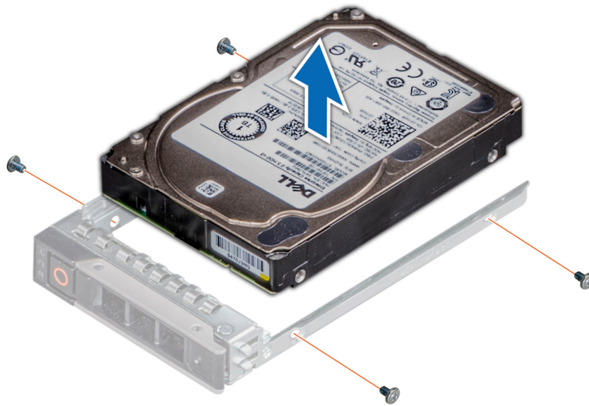
Figura 57. Extracción de la unidad de disco duro del portaunidades de disco duro
