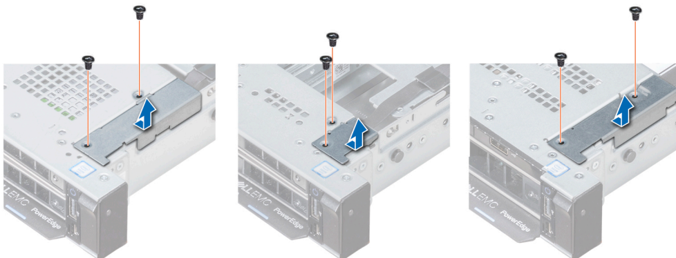
Figura 79. Extracción de la cubierta de cables
